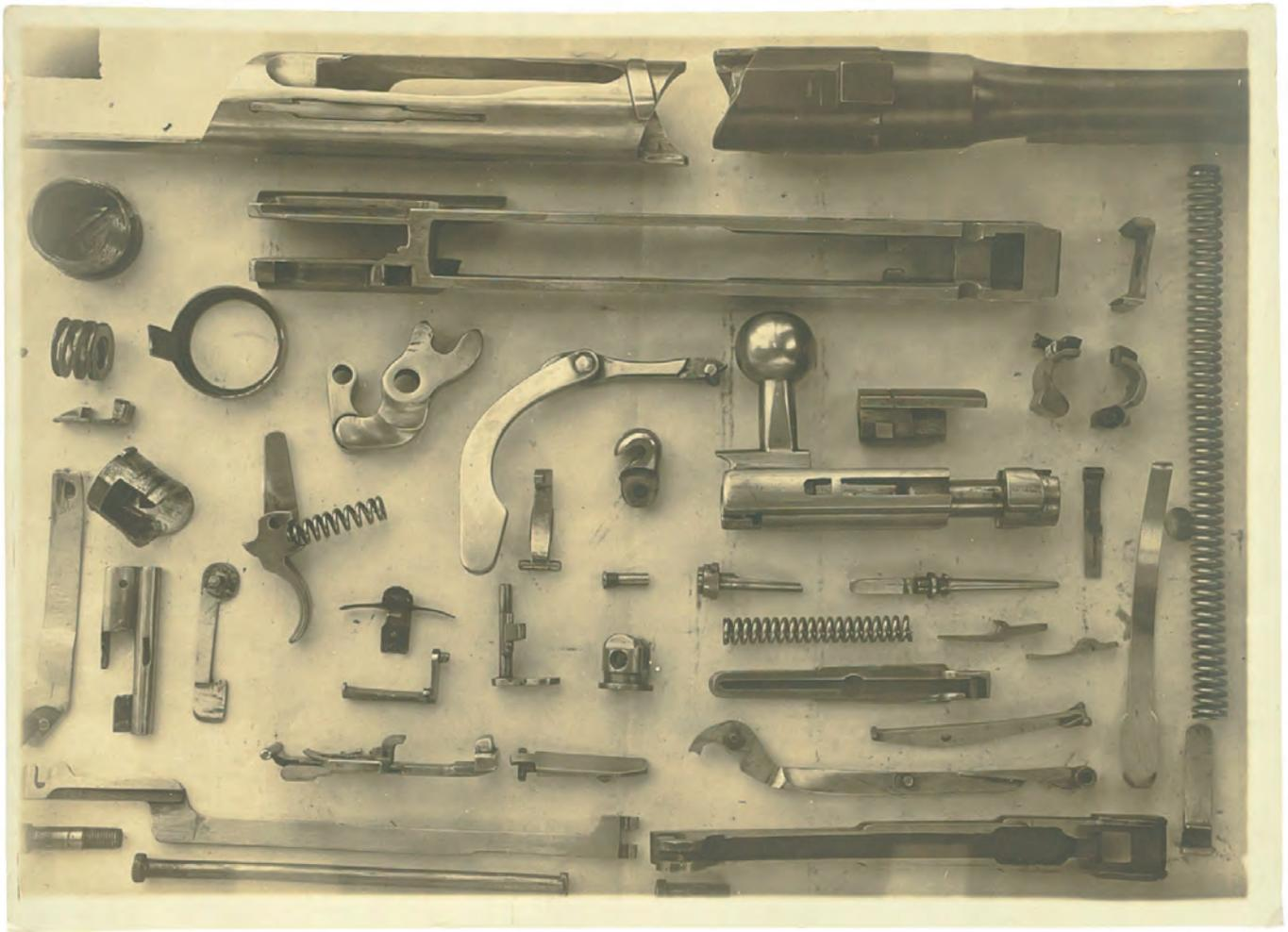
**36 Фотография опытной самозарядной винтовки системы Ф.В. Токарева образца 1910 г. (1913?) в разобранном виде.**
