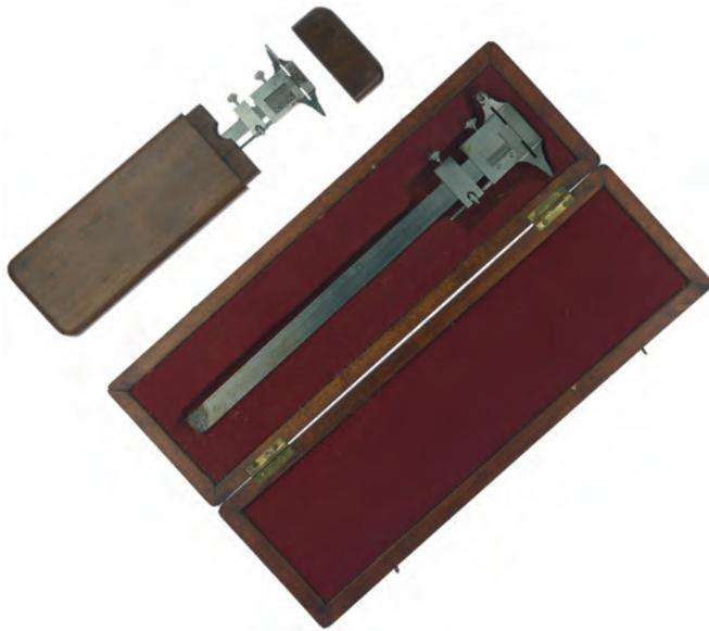
**94 Два штангенциркуля в деревянных футлярах и транспортир чертежника.**
